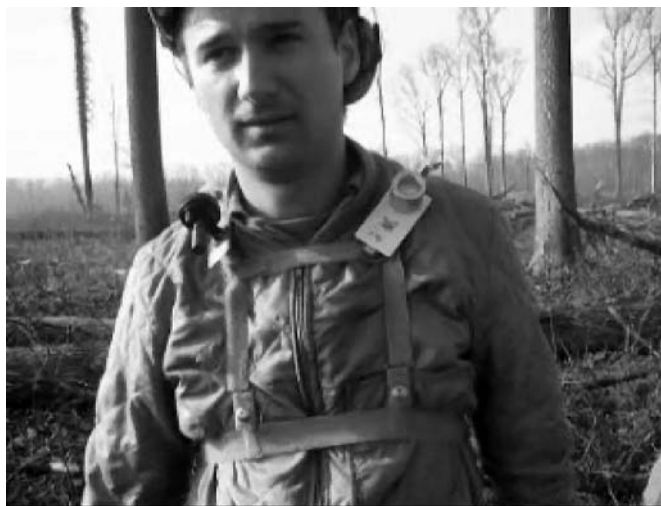
Figure 2: Filter holders for collecting total dust and respirable particles Abbildung 2: Filterbehälter zum Sammeln von Gesamtstaub und einatembaren Partikeln
