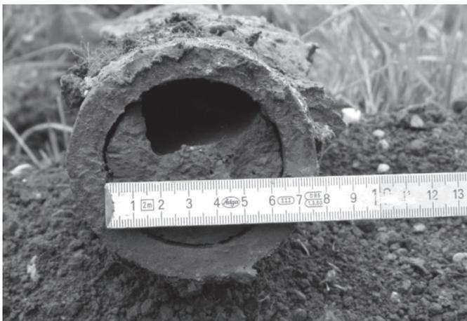
Abbildung 1: Mit Sediment gefülltes Drainrohr
