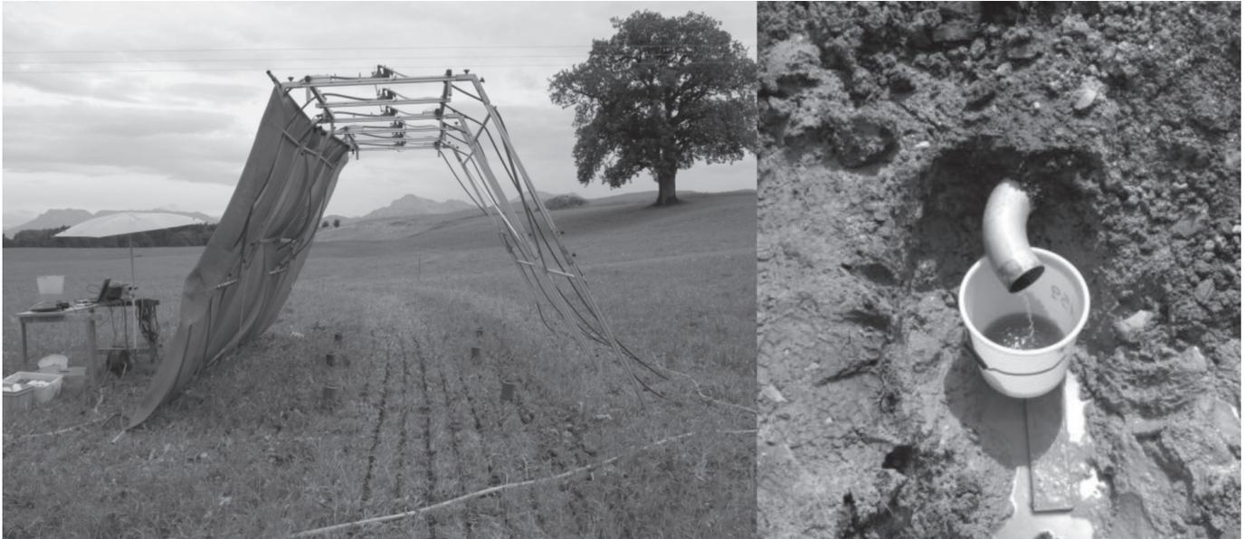
Abbildung 7: Regensimulator BAW Petzenkirchen (links); Drainauslass mit Ableitstutzen für Probenahme (rechts)
